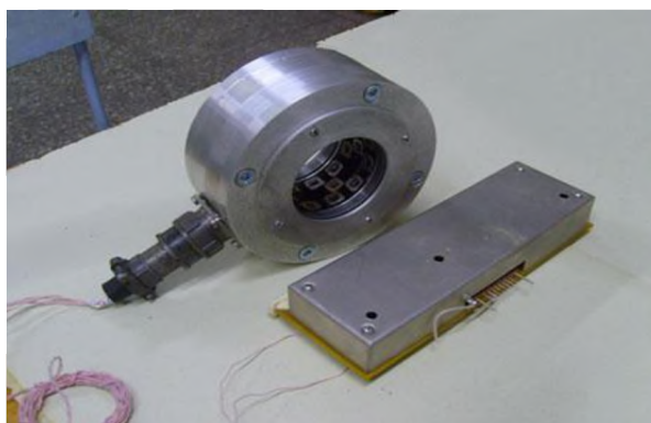
Рис.4. Общий вид магнитоупругого датчика МД-60.
