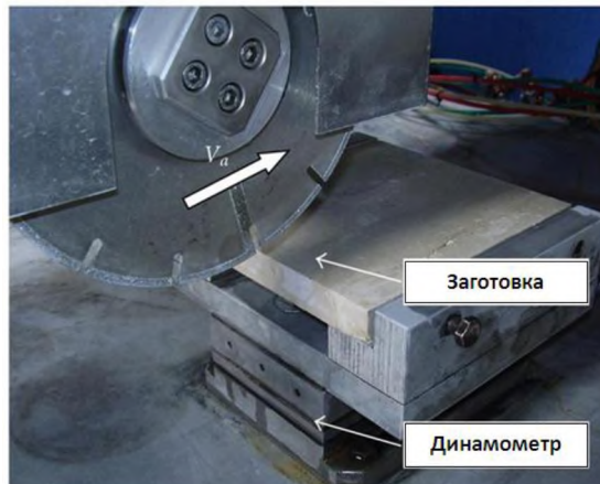
Рис.5. Динамометр для измерения сил резания P_x , P_y , P_z .
