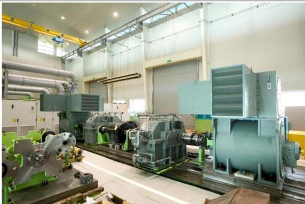
Рис. 7. Испытательная станция элементов привода
