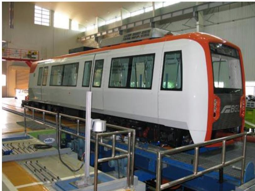
Рис. 5. Динамические испытания модели кузова
