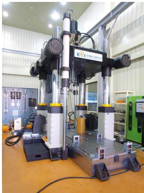
Рис. 4. Большая трех-координатная система испытания балласта (основания пути)
