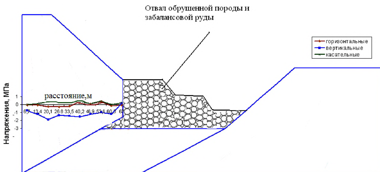
Рис.4. Распределение напряжений в прибортовом массиве после полной выемки запасов прибортовой зоны
