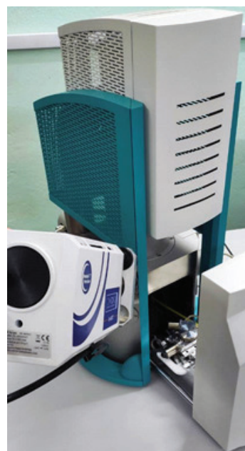
Рисунок 2 – СЭМ TESCAN Vega 3 LMN, с хим. анализатором Oxford X-ACT
