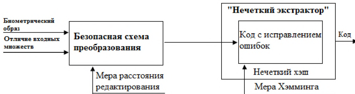
Рисунок 2 – Схема преобразования нечетких биометрических данных личности в код
