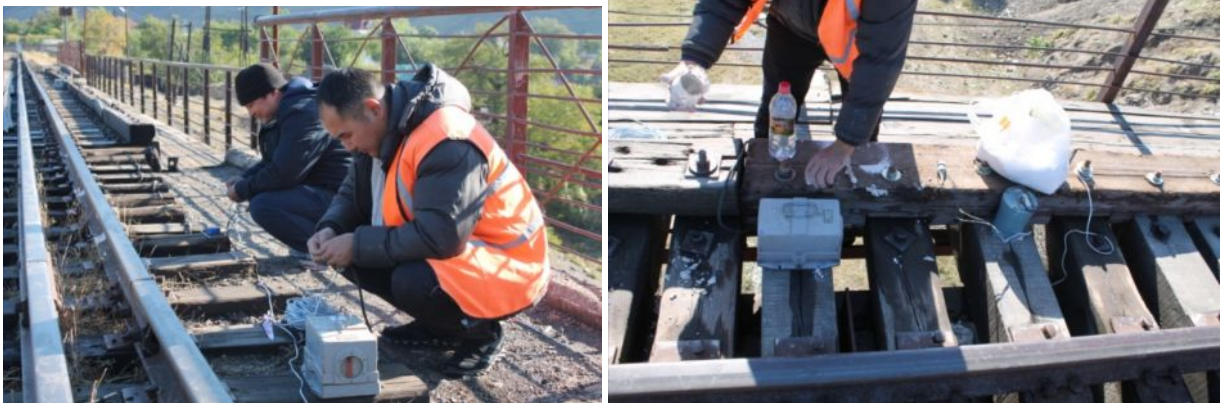
Рис.6. Установка сейсмоприемников на пролетные строения (СМ-3 и СМВ 30S)
