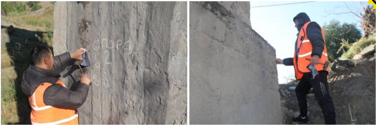
Рис. 4. Определение класса бетона по прочности
