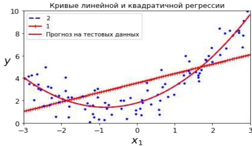
Рис.1. Применение линейной регрессии с полиномами различных 2 степени
