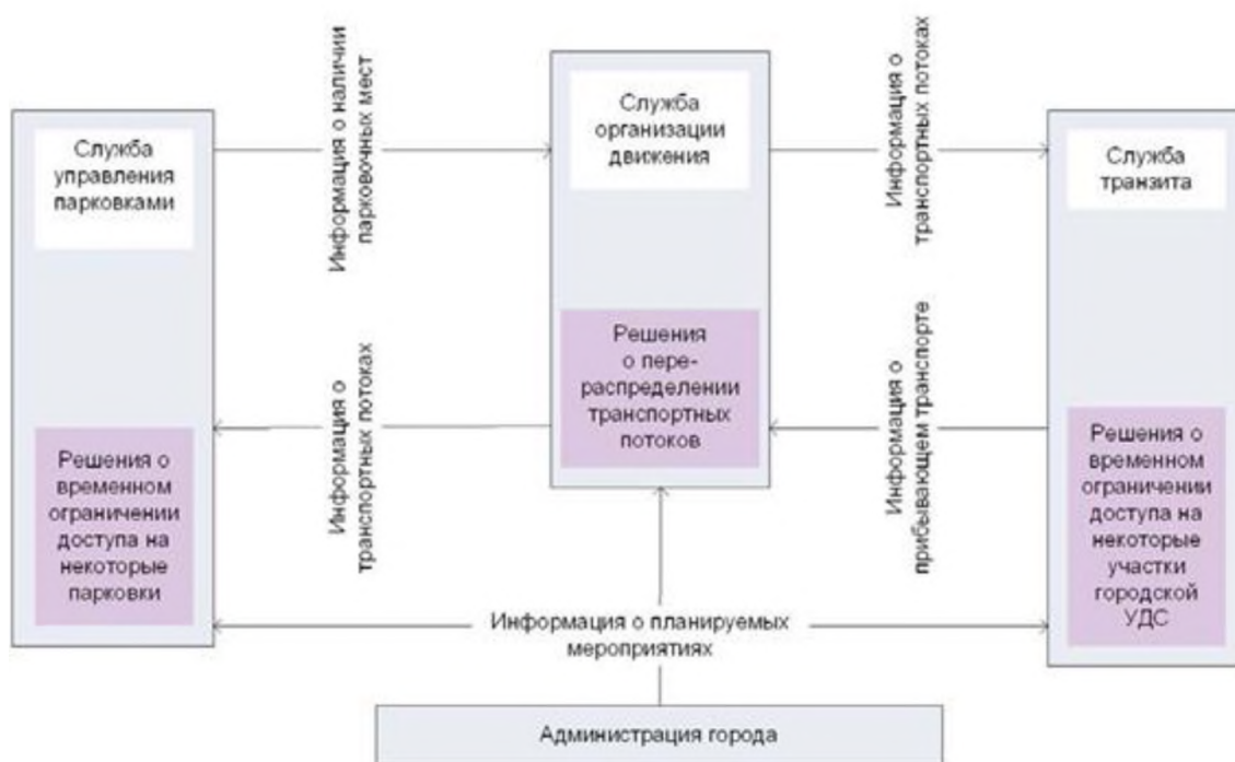
Рисунок 2 - Схема информационного обмена между некоторыми модулями ИТС
