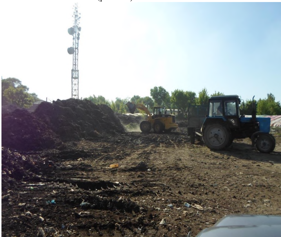
Рис. 1. Штаблеукладчик, оборудованный ковшем объемом 2 м 3 для периодического перемешивания компоста
