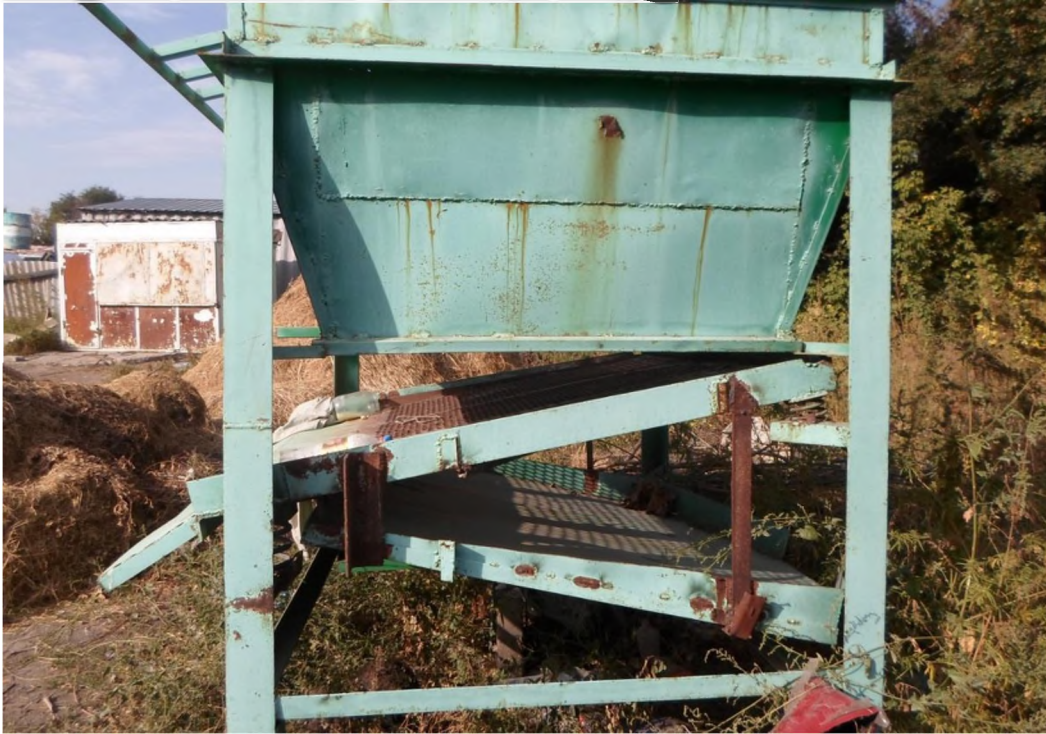
Рис.2. Вибросито трехступенчатое для фракционирования готового компоста.
