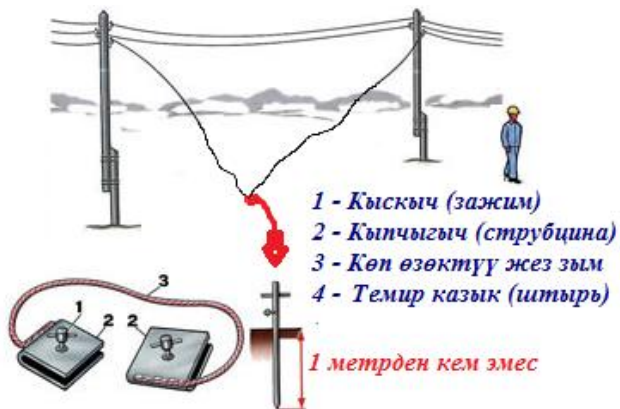
40 – сүрөт. Токту жерге жиберүү (заземление).
