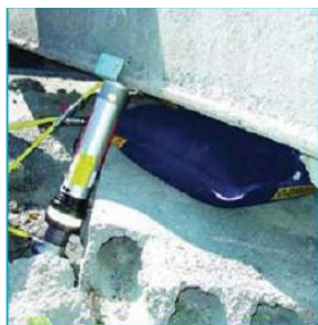
а–үйлөмө жаздыкты, тайап көтөргүчтү бирге колдонуп көтөрүү
