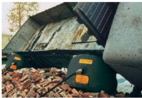
б – үйлөмө жаздыктын жардамы менен машинаны тике тургузуу
