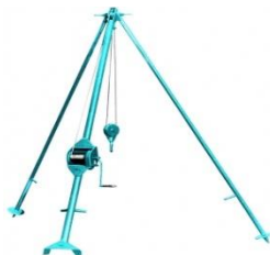
б–үч түркүктүү кол буроо жүк көтөргүч 29 – сүрөт.
