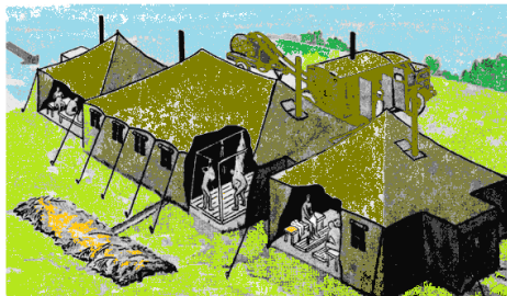
59 – сүрөт. Зыйансыздандыруучу жайдын кеңир таркалган схемасы (а) жана жалпы көрүнүшү (б): 1 – документ жана баалуу буйумдарды кабыл алуучу жай; 2 – чечинүүчү жай; 3 – жууңуучу жай; 4 – таза кийим кийүүчү жай; 5 – документтерди жана баалуу буйумдарды кайтарып берүүчү жай; 6 – зыйансыздандыруучу душу бар атайын машина (ДДА); 7 – калдык суу чогултуучу жайлар; 8 – калдык суу агуучу арыкча; 9 – таза кийимдер кампасы; 10 – шыпаагерлер жайгашкан орун.
