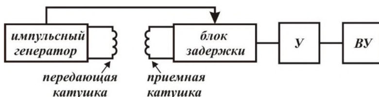
Рис. 3. Принципиальная схема импульсного ТИ
