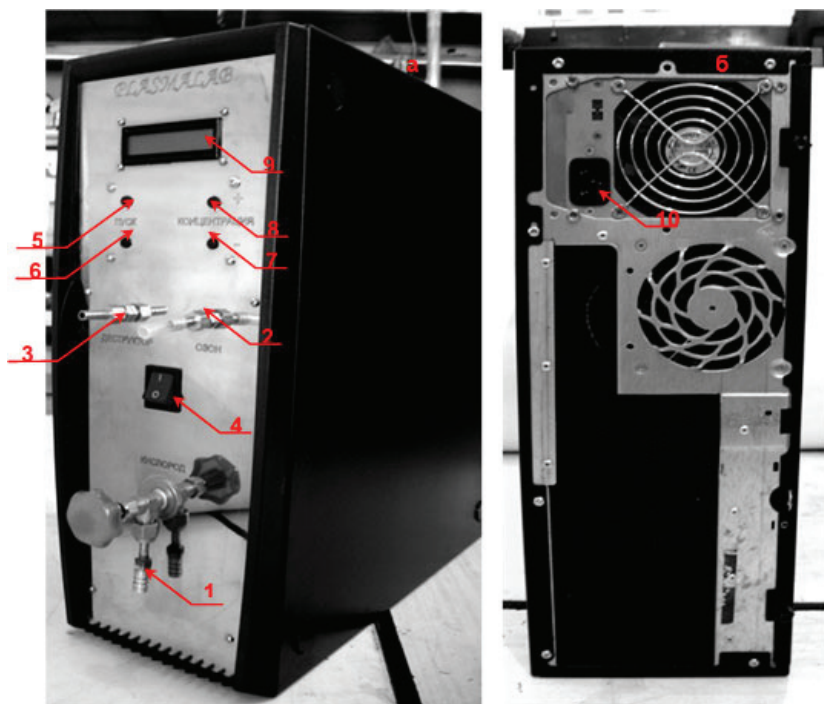
Рисунок 1.76 – Опытный образец озонатора PLASMALAB
