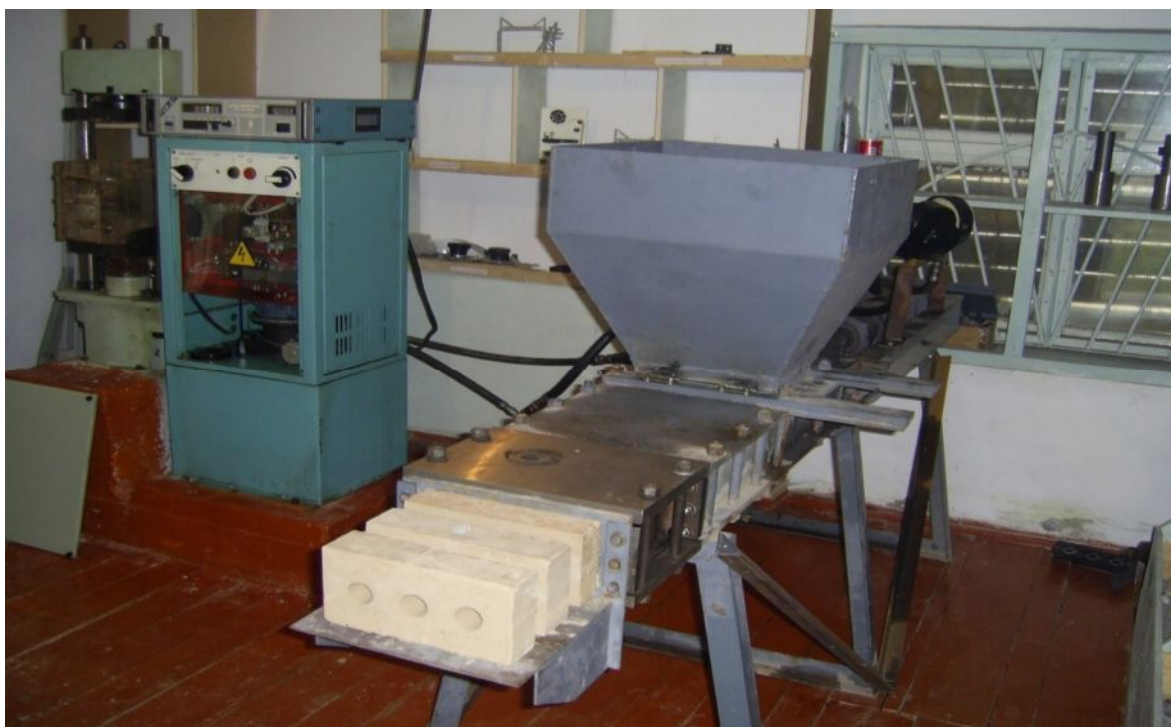
Рис. 2.2. Общий вид горизонтального экструзивного прессового оборудования
