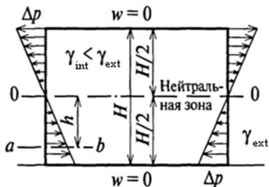
Рис. 2.4. Схема расположения нейтральной зоны при наличии теплового напора
