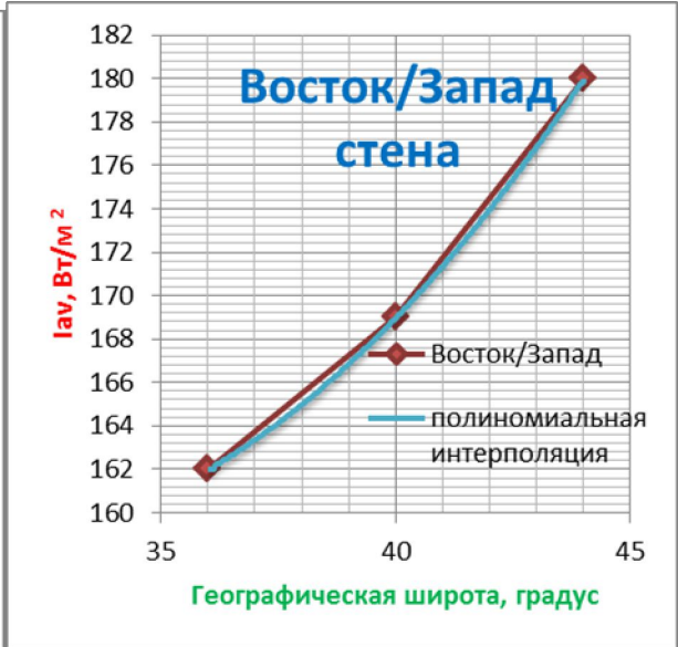
Рис. 3.13. Среднесуточная поверхностная плотность потока солнечной радиации поступающей на поверхность различной ориентации, в июле
