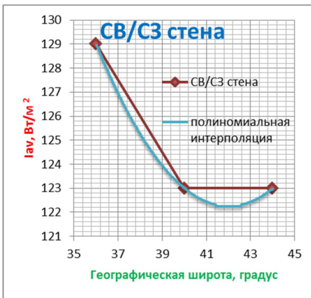
Рис. 3.13. Среднесуточная поверхностная плотность потока солнечной радиации поступающей на поверхность различной ориентации, в июле
