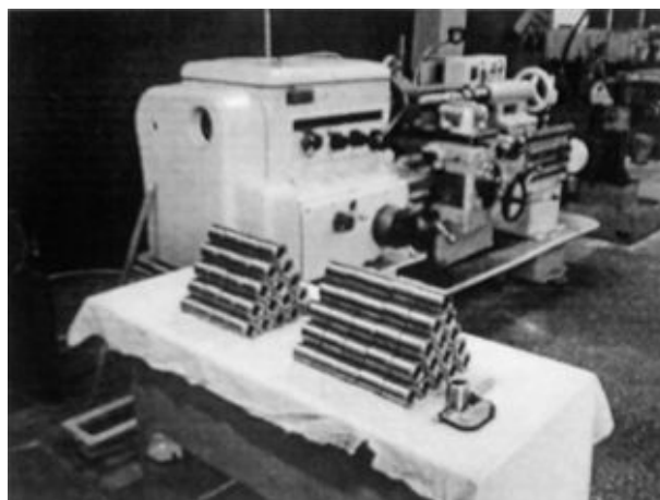
Рис. 2. Фотография стенда по определению полей рассеивания размеров деталей
