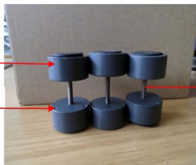
Рис.4.Неодимые постоянные магниты с промежутками
