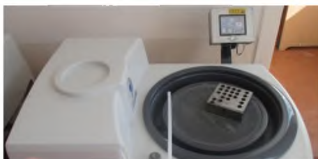
Рис.2. Minitech 233–ручная однодисковая шлифовально-полировальная машина с варьруемой скоростью вращения.
