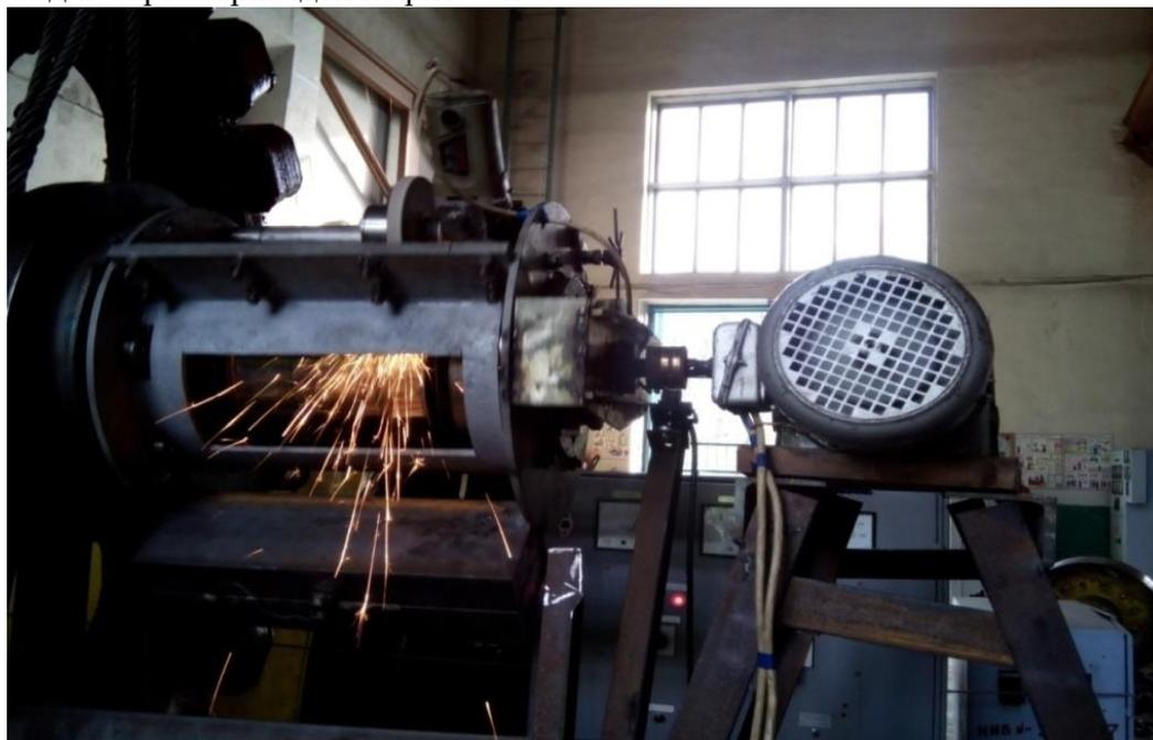
Рис. 3. Универсальный переносной станок для проточки и шлифовки шейки генераторного вала
