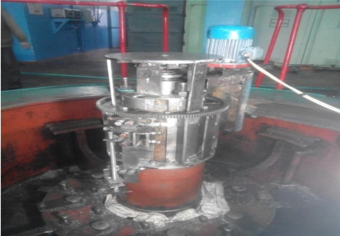
Рис. 4. Универсальный переносной станок для проточки генераторного вала
