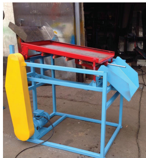
Рисунок 1 – Общий вид вала сепаратора листовой части трав
