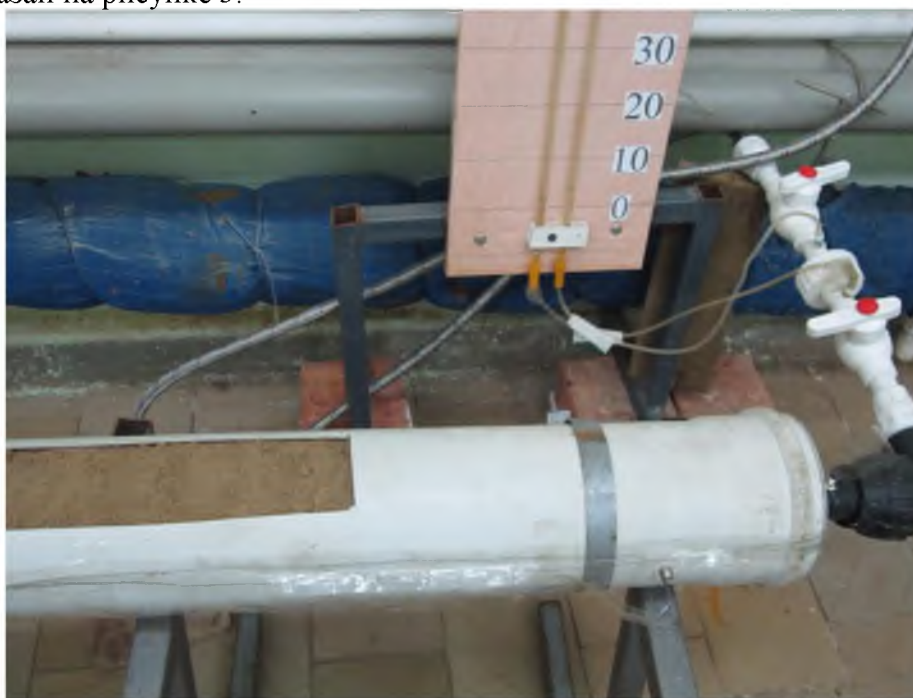
Рисунок 3 – Экспериментальный стенд для процесса теплообмена в системах грунт-вода
