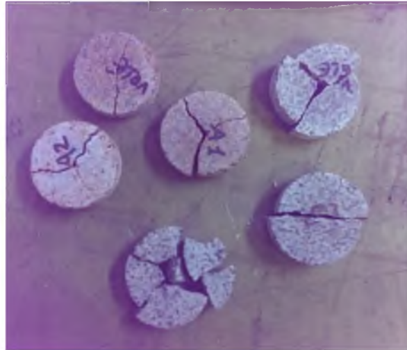
Рис.1. Виды разрушения образцов горных пород при расколе
