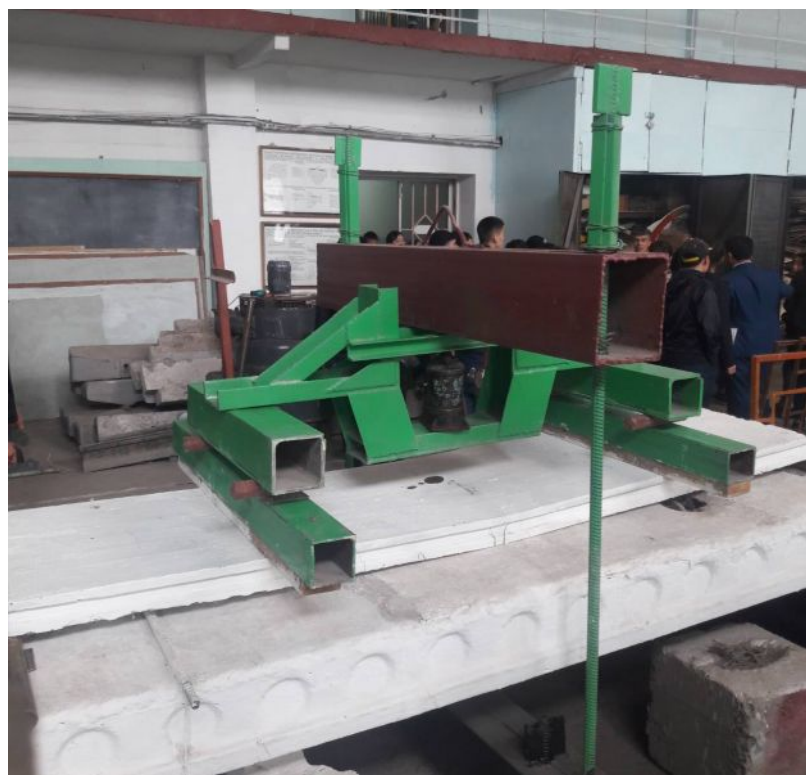
Рис. 2. Схема расположения панели из пенобетона при статических испытаниях
