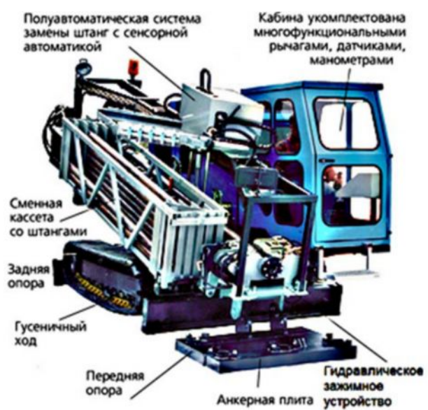
Буровой станок Grundodrill 205 Tracto-
