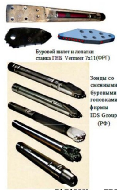
головки для бурения пилотной скважины при бестраншейной
