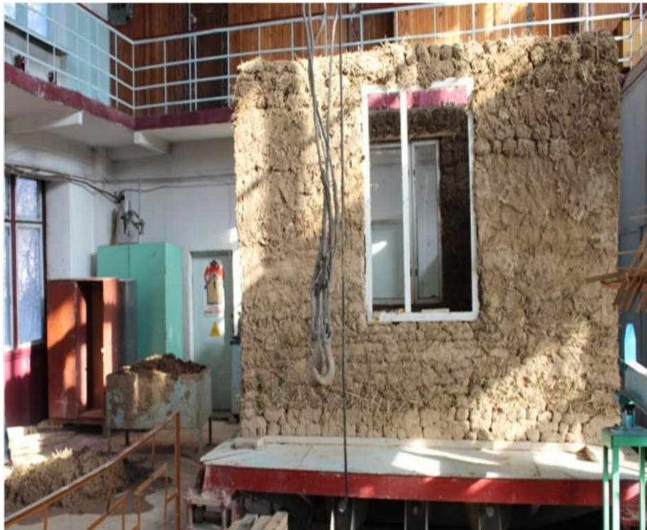
Рис.2. Вид модели здание из глины (пахсы)
