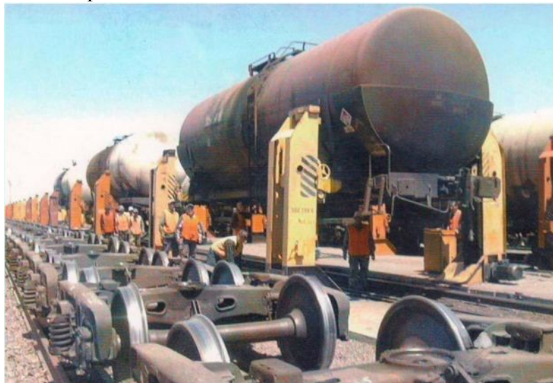
Рис.4. Смена тележек грузового вагона
