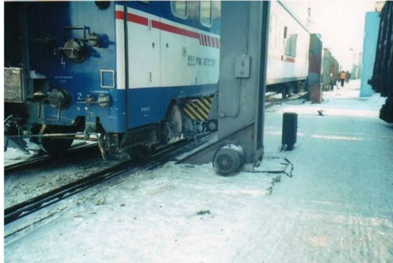
Рис.3. Смена тележек пассажирского вагона
