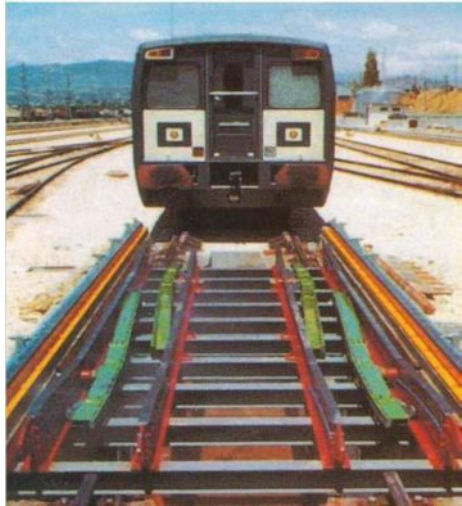
Рис.5. Схема узла рельсовых путей системы Talgo для смены колеи
