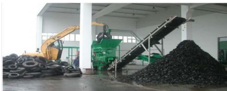
Рис. 3. Полученная при ізмельчэнні резиновая крошка
