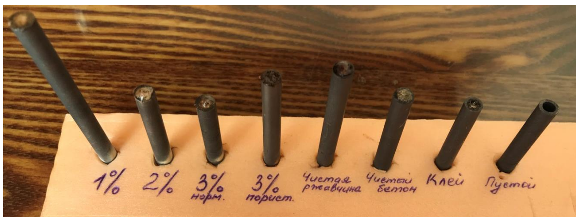
Рис. 6. Графитовые образцы для проведения спектрального анализа
