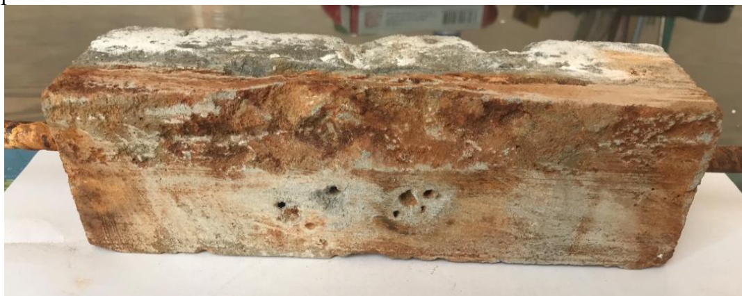
Рис. 4. Образец, подверженный электрокоррозии
