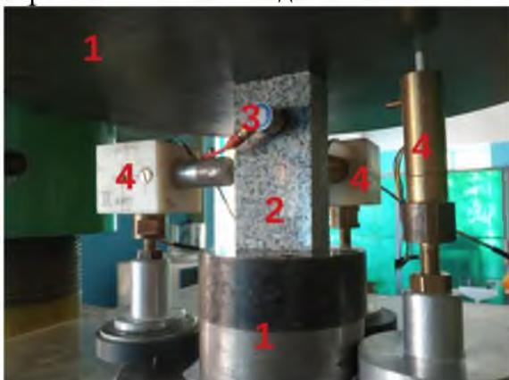
Рис. 1. Образец геоматериала (гранит) перед началом эксперимента:
