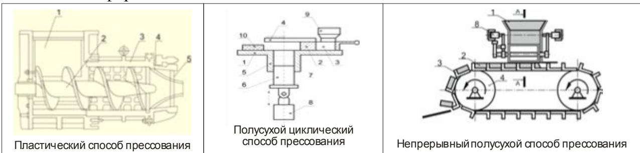
Рис. 1. Принципиальные схемы прессов циклического и непрерывного действия
