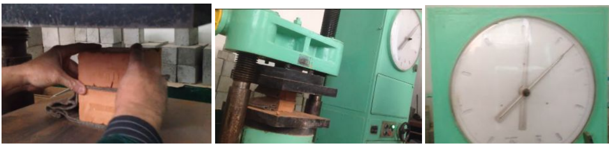
Рис.11. Общий вид стендовой установки для испытания прессуемой смеси и образцов изделия
