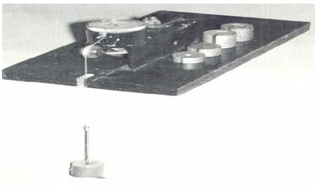
Рис. 2.7. Прибор для исследования структурно-механических характеристик керамических масс (Прибор Толстого)
