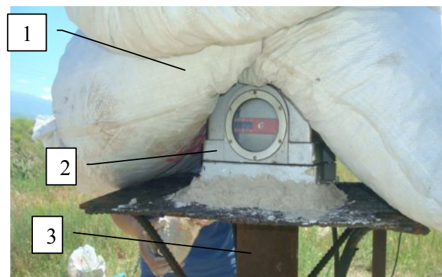
Рис.П.6.2.12. Фиксированные сейсмоприемники на модели: 1-сосредоточенный груз, 2-сейсмоприемник СМ-3, 3 - опора
