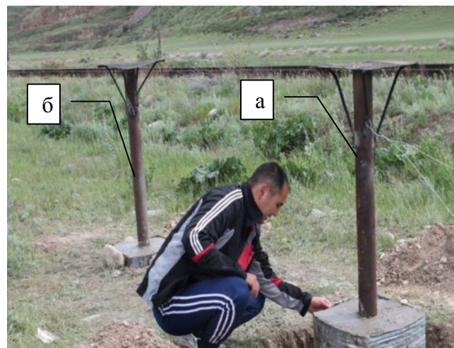
Рис.П.6.2.6. Измерение фактических размеров моделей а) на гравийной сейсмоизолирующей подушке; б) на естественном основании
