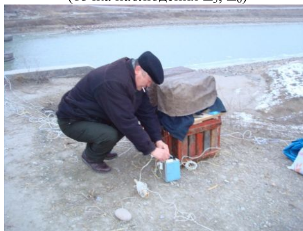
Рис.П.6.1.4. Установка пускового устройства ПУ-1 (пускач)
