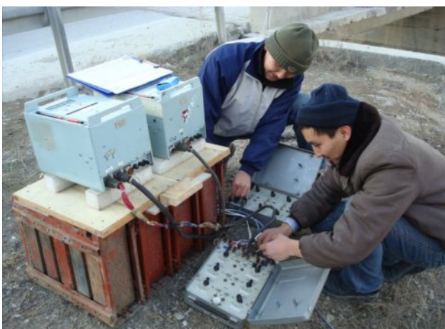
Рис.П.6.1.3. Установка приборов сеймостанции
