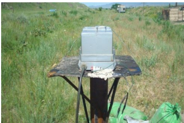
Рис.П.6.2.9. Установка на модели опор сейсмоприемников СГ-10 и СМ-3
