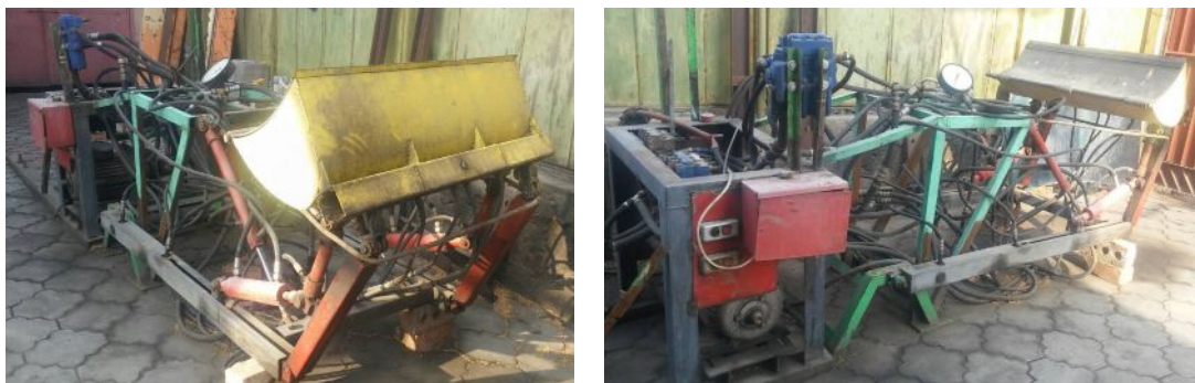
Рис.12. Физическая модель бульдозера-погрузчика с трансформирующимся рабочим органом
