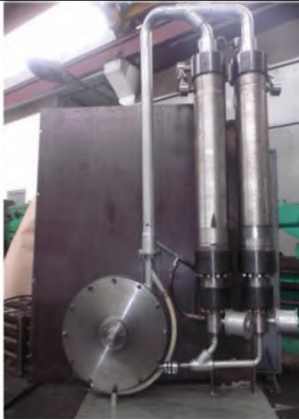
Рис. 4. Общий вид парогидравлической турбины: Диаметр рабочего колеса – 500 мм; Рабочее давление пара - 50 МПа; Скорость вращения колеса – 1500 1/мин; Масса турбины без гидроускорителей – 220 кг; Полная масса установки с фундаментом – 1038 кг; Габариты 1100x 650x 2200мм
