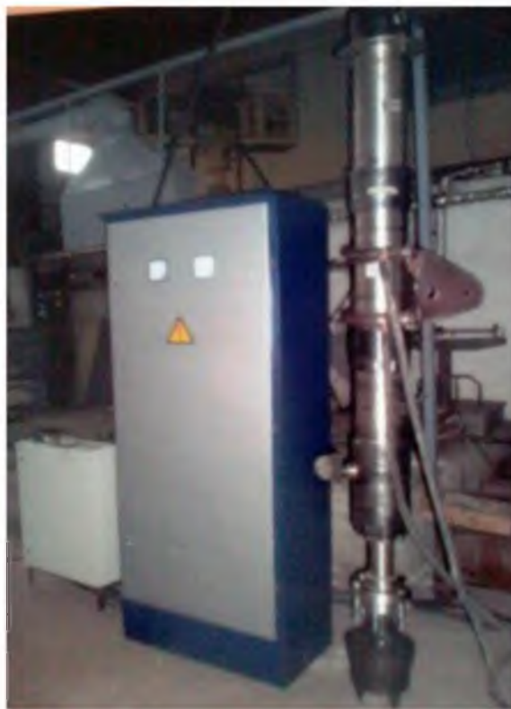
Рис. 5. Общий вид гидроимпульсного бурового снаряда Энергия струй обеспечивается электроразрядным процессом в полости бурового
