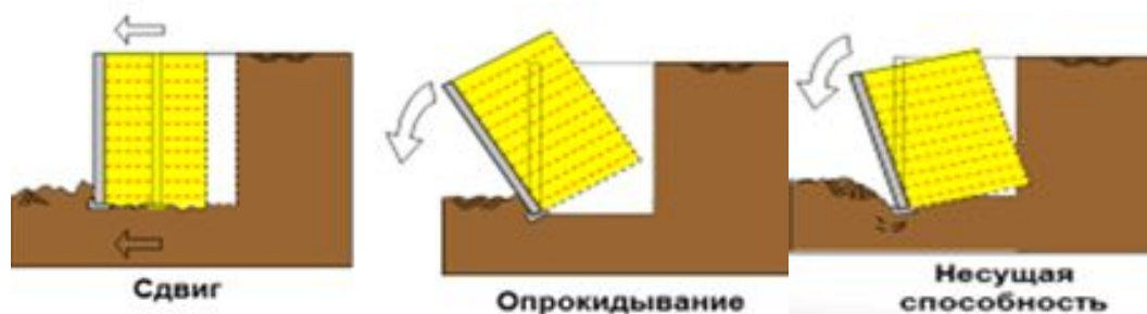
Рис. 4. Механизмы разрушения армогрунтового сооружения
