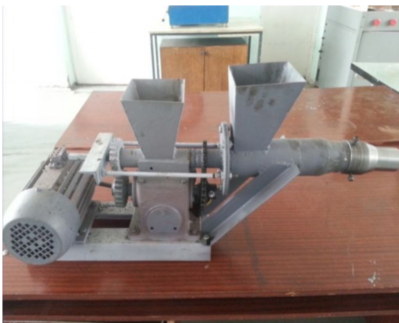
Рис. 1. Шнековый пресс для формирования слоистых угольных брикетов или с «внутренней» начинкой
