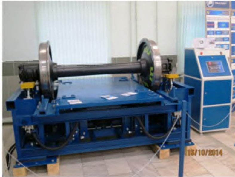
Рис.12. Вибродиагностический комплекс «Эксперт Д»
