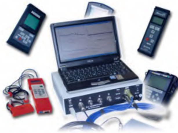
Рис.1. Примеры вибродиагностического оборудования российского производства
