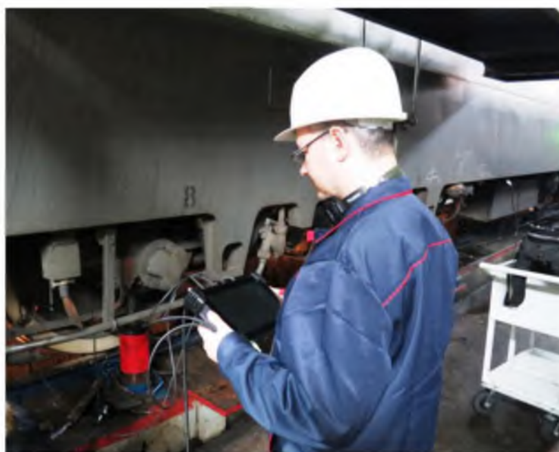
Рис.14. Диагностирование КМБ локомотива системой «Эксперт М»
