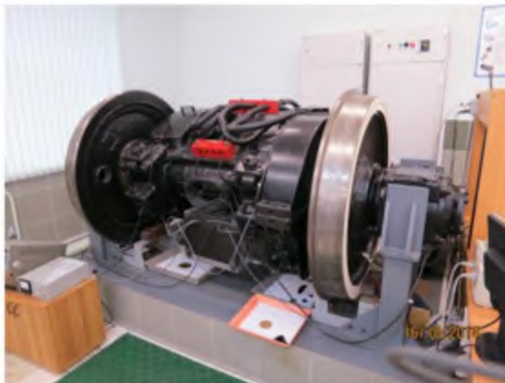
Рис.10. Система вибродиагностирования «Компакс-Экспресс»
