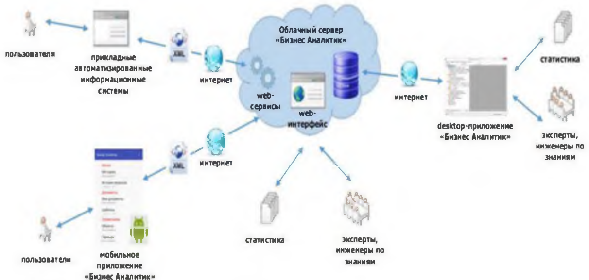
Рис. 9 Схема взаимодействия составных компонентов «Бизнес Аналитик» между собой и с пользователями
