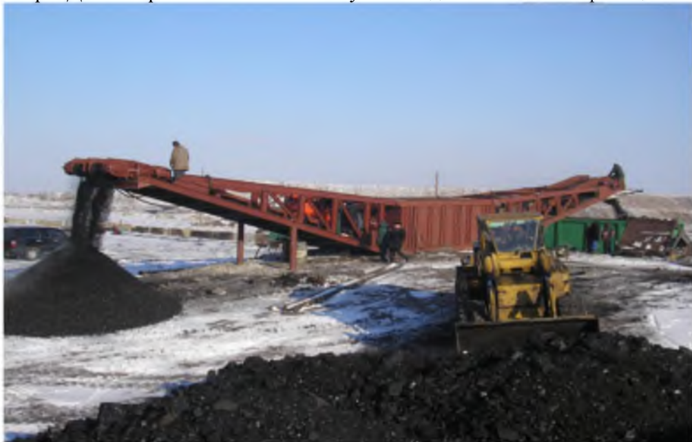
Рис. 2. Конструкция комплекса ДСКА производительностью 750 т/час в варианте поставки ООО “Каражыра” (Республика Казахстан)
