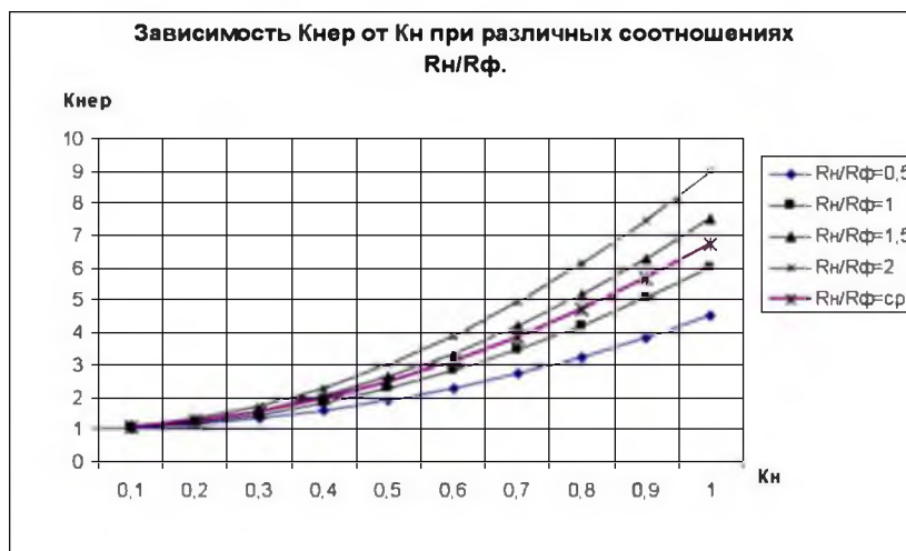
Рисунок 3. Зависимость коэффициента несимметрии K_n от коэффициента неравномерности нагрузок K_{\text{HEP}} .
