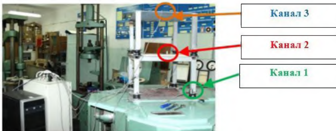
Рис. 1. Внешний вид СТД 2060 и расположение датчиков на макете
