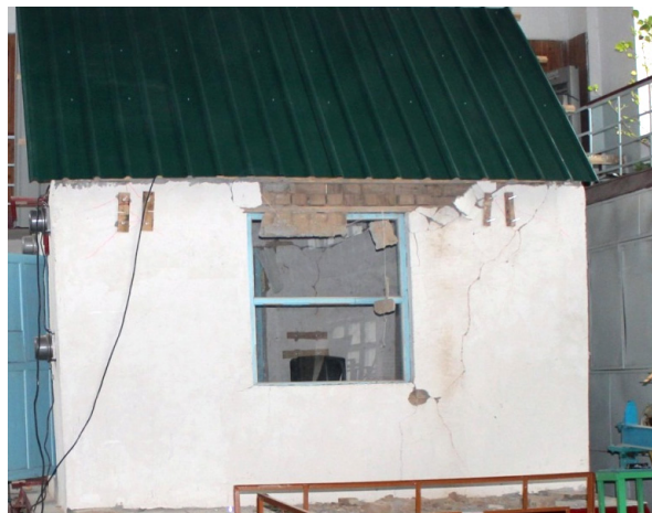
Рисунок 5 – Общий вид модели дома из кирпича-сырца после эксперимента
