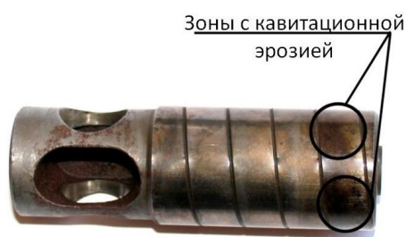
Рисунок 2 – Рабочая поверхность поршня регулятора с кавитационной эрозией
