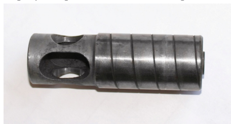
Рисунок 3 – Рабочая поверхность поршня регулятора с эмульгатором 6СФК-180-0,5
