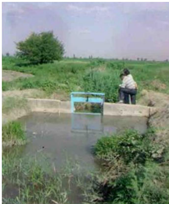
Рис.3.5. Водомер типа «Водослив-насадок» на Р-8 системы ЗБЧК (работает водомер типа «Насадок») [93]
