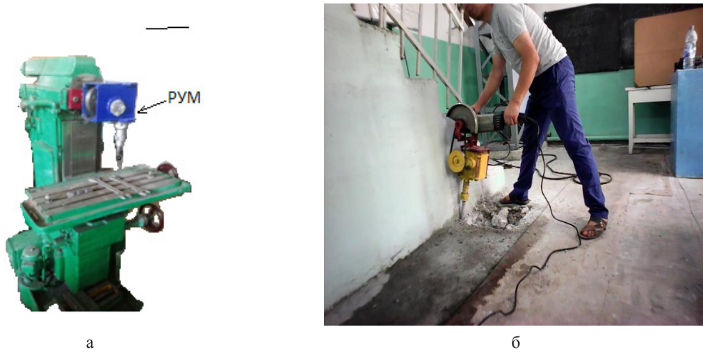
Рисунок 1 – Общий вид виброударной установки на базе универсально-фрезерного станка для фактурной обработки природного камня (а) и общий вид ударной машины с приводом от УШМ (б)
