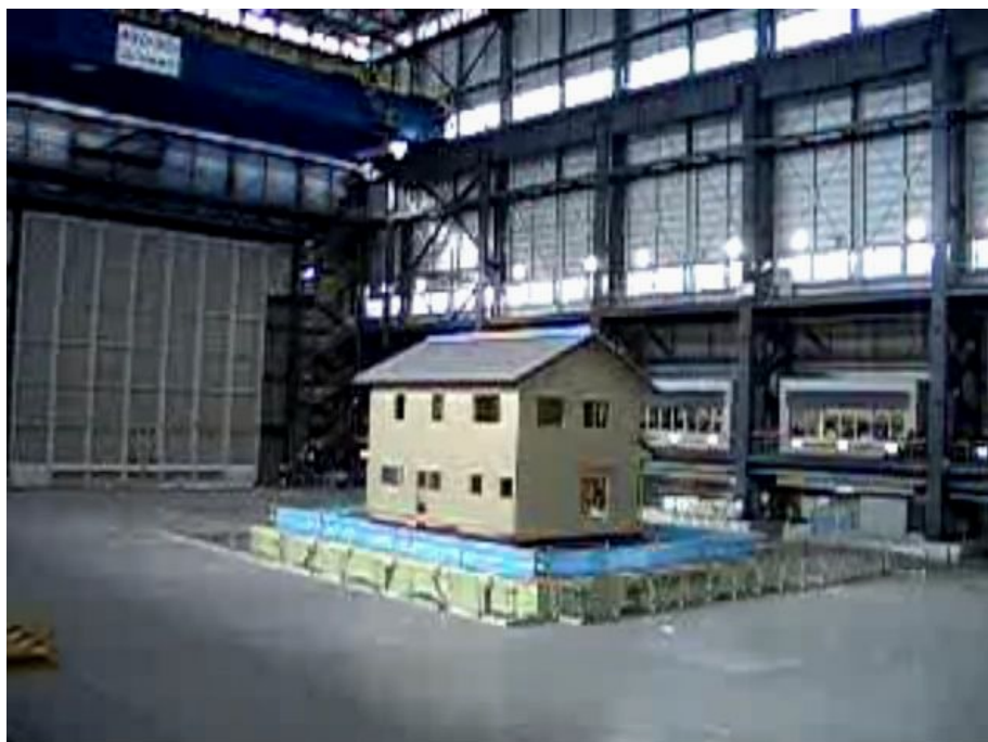
Рис.2. Здание в натуральную величину на E-Defense сейсмоплатформе в Японии
