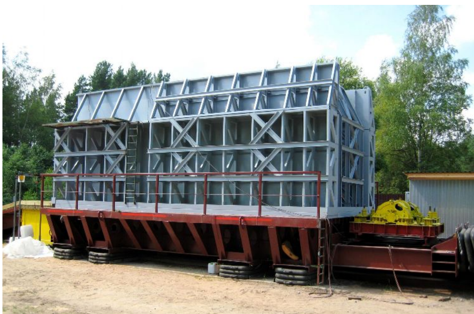
Рис.1. Стенд УСП-300 (универсальная сейсмоплатформа)
