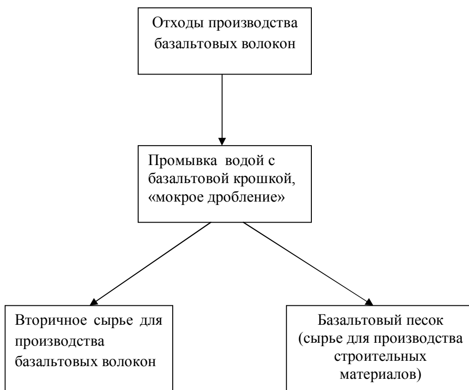
Рис. 2. Технологическая схема переработки отходов базальтового производства
