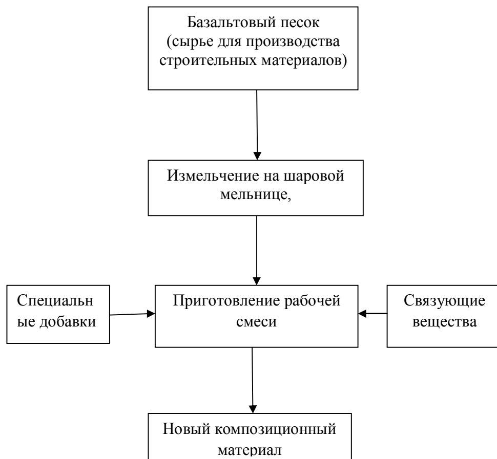
Рис. 7. Схема переработки вторичного отхода производства базальтовых волокон
