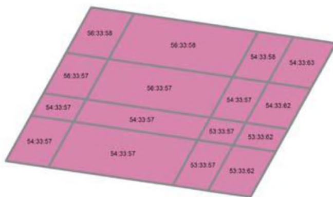
Рис.6. Структура объединенного слоя спектральных каналов диапазона VNIR
