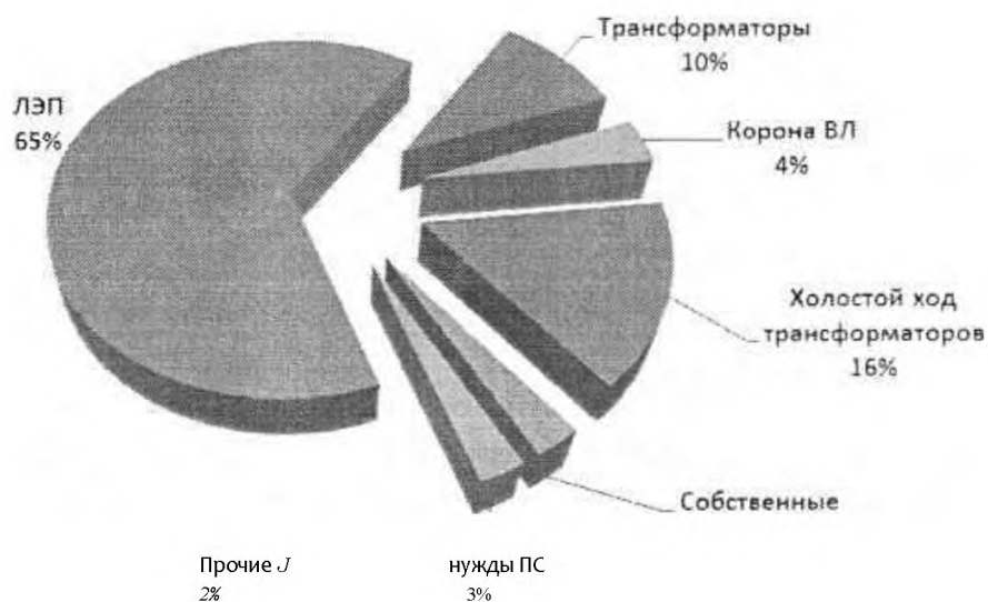
Рис. 1. Среднестатистические составляющие структуры технических потерь электроэнергии в электрических сетях (страны СНГ).
