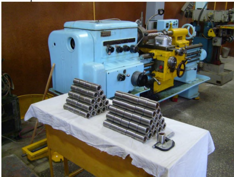
Рисунок 3 – Фотография стенда по определению полей рассеивания размеров деталей
