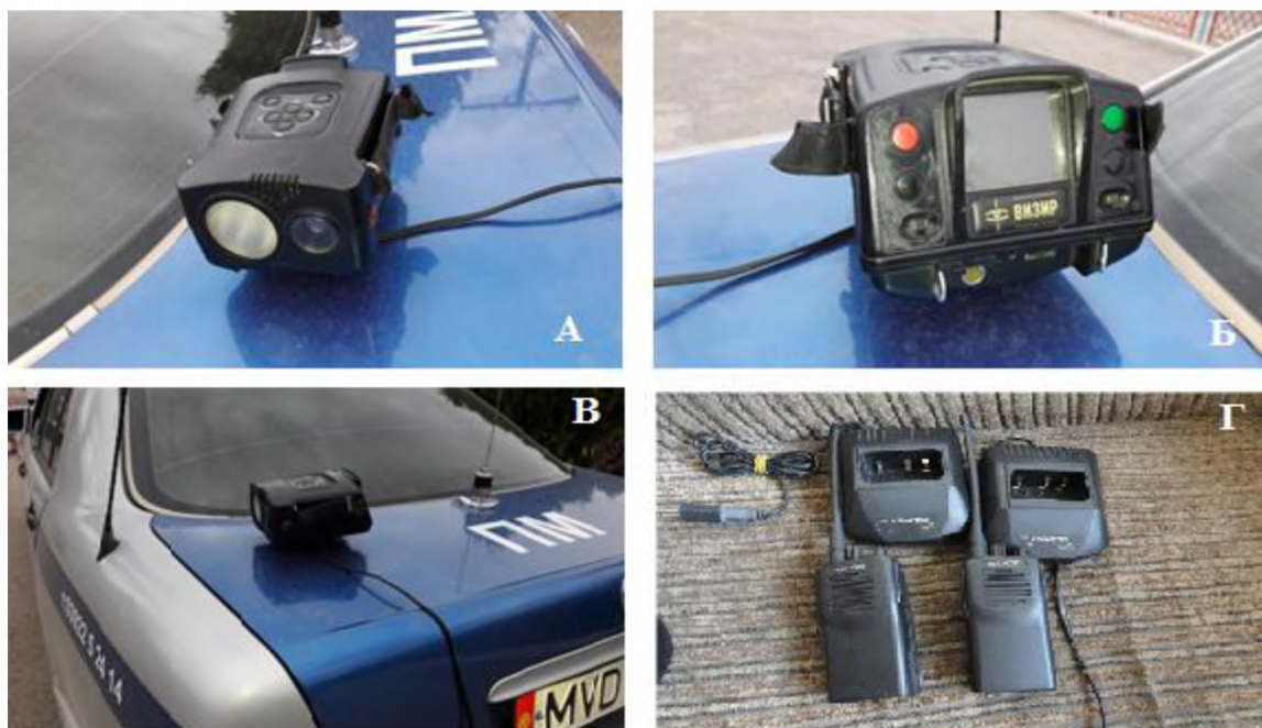
Рис. 2 Оборудование для исследования А, Б, В - видеозаписывающий радар «Визир», Г – рация Kenwood ТК3107
